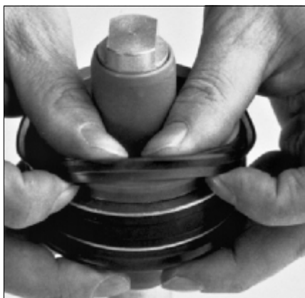
Рис. 6.27 Ручной монтаж уплотнения поршня
