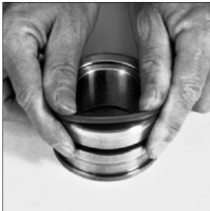
Рис. 4.29 Надевание полиуретанового защитного кольца
