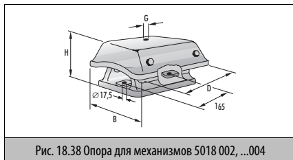
Рис. 18.38 Опора для механизмов 5018 002, ...004
