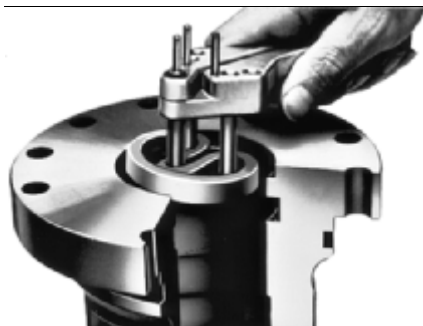
Рис. 4.24 Монтажный инструмент I для уплотнений штока
