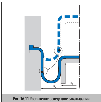
Рис. 16.11 Растяжение вследствие закатывания.
