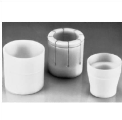
Рис. 6.28 Монтажная оснастка для поршневых уплотнений
